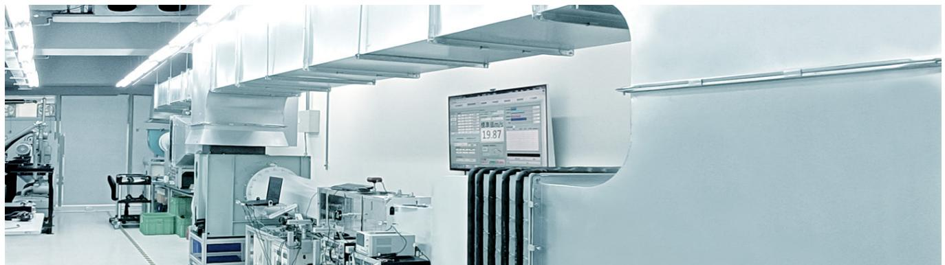
风洞校正系统可提供校正时的标准化稳定环境，并且在运行中不受外界因素干扰，再搭配自动化检测系统，大幅提升风速产品校正后的精确度与可靠性。此风洞系统遵循ISO/IEC 17025的运作标准，可另行加购校正报告。
