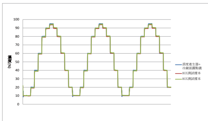
误差精度曲线图：（IEC 61298/ISO17025 标准）
