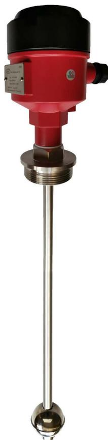
LB100系列浮球液位上升或下降时，带动不锈钢磁性浮球上下移动，浮球触发检测杆中的磁簧开关，发出信号。测量范围为从 0 - 2 米
