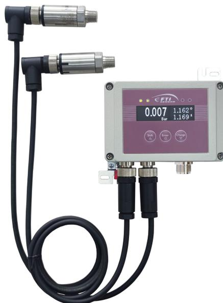
QP100差压变送器，包含两个压力输入单元，可根据不同工况测量两点差压值，经过综合运算，将两点差压值所对应的的模拟量信号输出给PLC或检测单元，同时具备开关报警功能。
